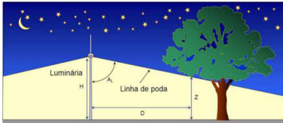
Projeção da desobstrução longitudinal - fonte: ND-3.4 Cemig
