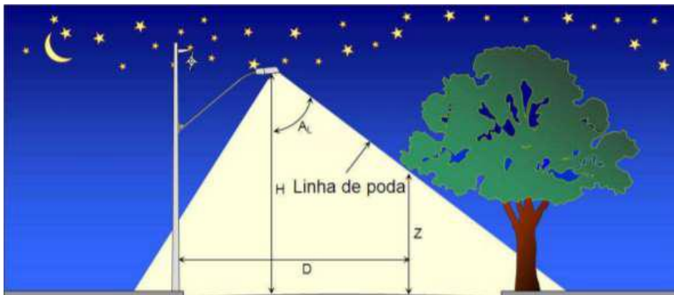
Projeção da desobstrução lateral - fonte: ND-3.4 Cemig
